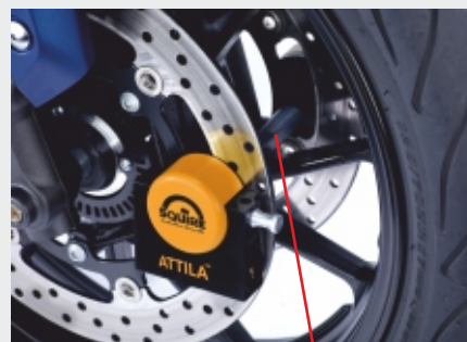
Attila chiuso sul freno a doppio disco, si noti l'uso del perno lungo e dei distanziatori appropriati.
